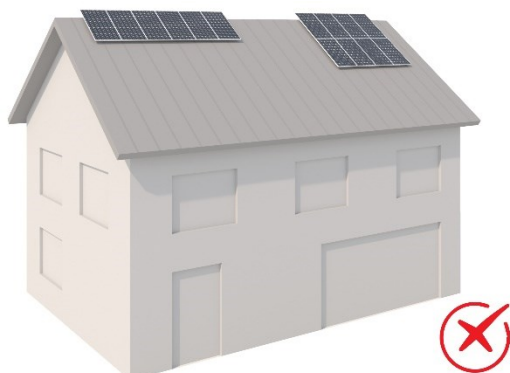
Slika 13: Primer neustrezne postavitve fotonapetostnih modulov na streho, saj so višji od slemen
